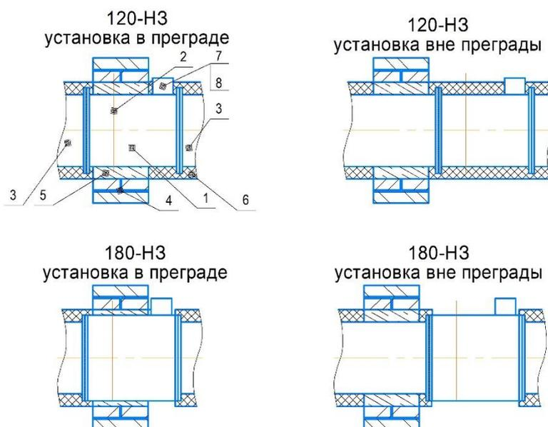
1 - клапан; 2 - ось заслонки; 3 - воздуховоды; 4 - строительная конструкция с нормируемым пределом огнестойкости; 5 - цементно-песчаный раствор; 6 - наружное огнезащитное покрытие; 7- защитный кожух; 8 - привод.
